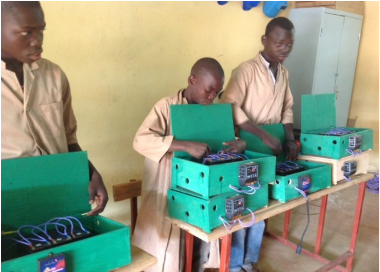
jugendliche Straßenkinder, die zu Elektrikern angelernt werden, bauen jetzt Solar-Home-Systeme für 30 und 40 W Solarmodule, mit 3 parallelverschalteten Batterien
