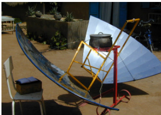
Der Solarkocher Papillon im Einsatz. Seine Leistung beträgt etwa 1 kW. Entwickelt wurde er am Solar-Institut in Jülich.
