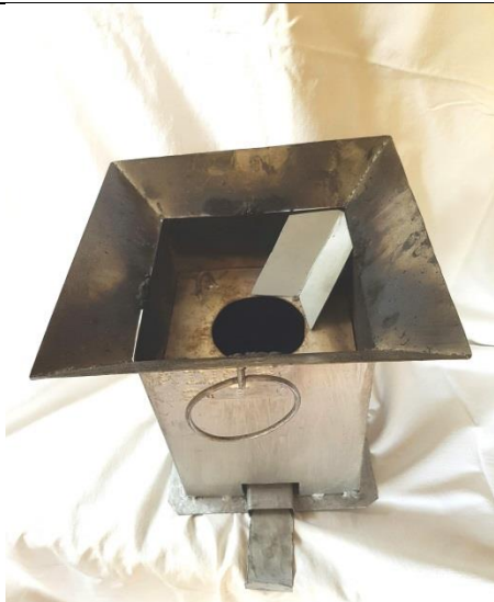
Réchaud avec glissière pour ajouter du combustible sans enlever la marmite et languette de réglage de l'arrivée d'air
